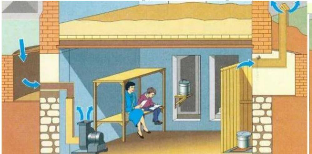
Один из наиболее надежных способов защиты населения от стихийных бедствий бурь, ураганов, смерчей, и от обычных средств поражения фугасного и осколочного действия, поражения обломками строительных конструкций и обрушения конструкций вышерасположенных этажей зданий различной этажности - использование в качестве **УКРЫТИЯ** подземных пространств зданий и сооружений различного назначения. К таким укрытиям в условиях города относятся подвалы и цокольные этажи индивидуальных жилых домов.
