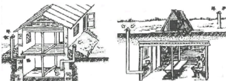
При отсутствии подземного пространства в многоквартирном жилом доме, пригодного для защиты людей, должны сооружаться простейшие укрытия.
